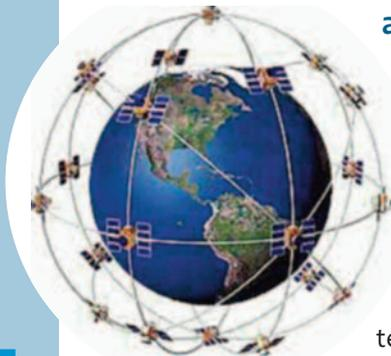
El sistema GPS es un sistema compuesto por una red de 24 satélites denominada NAVSTAR, situados en una órbita a unos 20.200 km. de la Tierra, y unos receptores GPS que permiten determinar nuestra posición en cualquier lugar del planeta, de día o de noche y bajo cualquier condición meteorológica. La red de satélites es propiedad del Gobierno de los Estados Unidos de América y está gestionado por su Departamento de Defensa (DoD).
